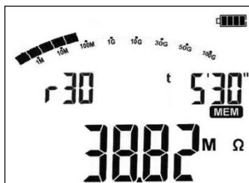
Значение сопротивления  $R_{ISO}$ , измеренное в момент времени  $t=5'30'$ . Символ  $r30$  обозначает выбранный отрезок времени, в котором зарегистрировано данное значение сопротивления изоляции.
