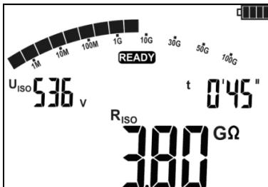
После окончания или прерывания измерения, на дисплее можно считать результат. Отображаются результаты всех измерений, которые были проведены (также в случае прерывания измерения). Если прибор переключился в состояние готовности, то результат измерения можно восстановить на экран клавишей **ВВОД**.
