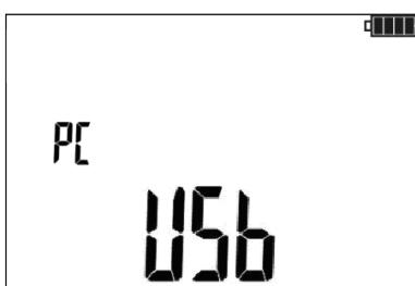
Подключите кабель от порта USB компьютера к разъему USB измерителя. На дисплее прибора отобразится сообщение USB.
