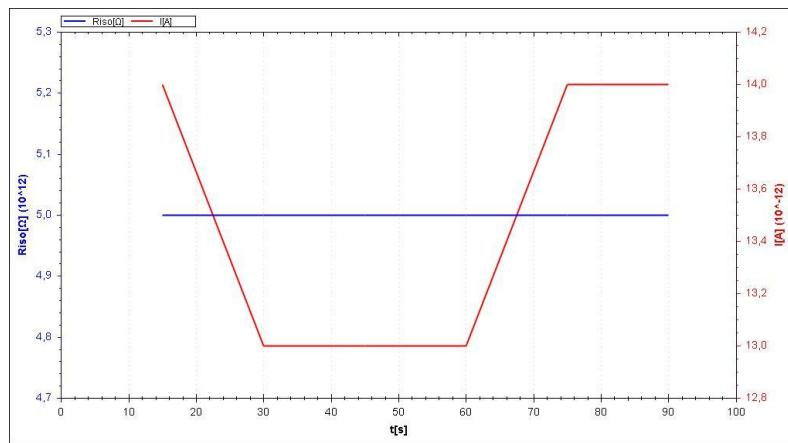
При измерении методом нарастающего напряжения **RampTest**, на основании выполненных измерений, пользователь может проанализировать характеристики напряжения, сопротивления и тока, как функции времени.
